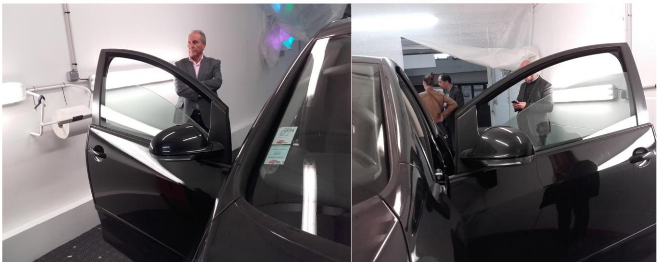
Vitrage d'origine : 73 % TLV (conforme).
