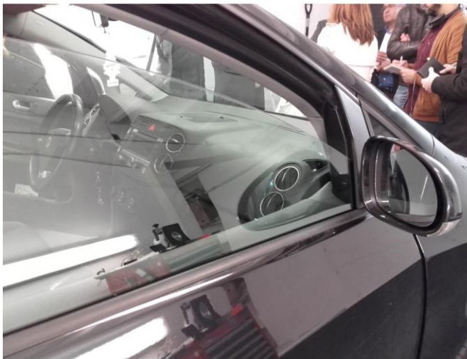
Vitrage d'origine : 73 % TLV (conforme).
