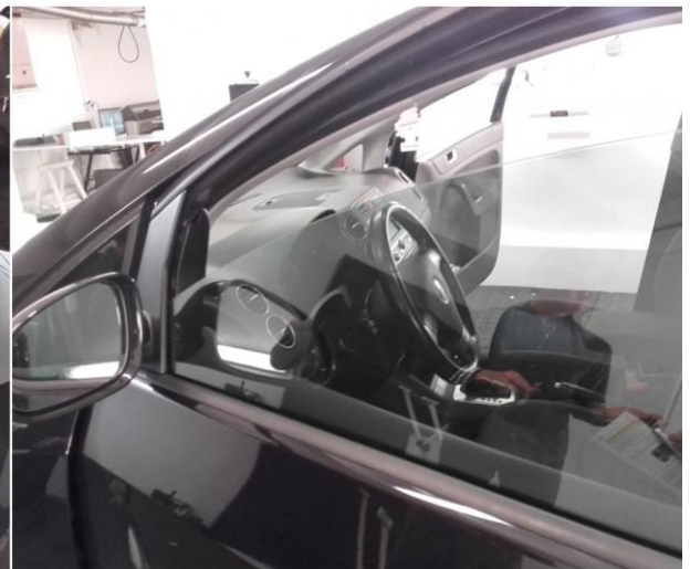
Vitrage filmé : 40 % TLV (non conforme).
