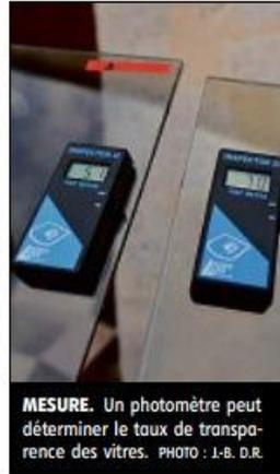
**MESURE.** Un photomètre peut déterminer le taux de transparence des vitres. PHOTO : I.-B. D.R.
