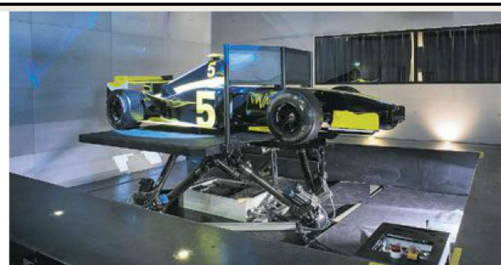
Chaque voiture repose sur un plateau. Celui-ci s'appuie sur six vérins commandés par des ordinateurs. Une fois au volant, c'est parti pour 3 minutes d'essais et 7 minutes de course.
